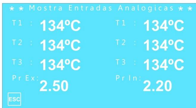
As temperaturas e pressões também podem ser visualizadas pelo display da unidade de comando. Utilizando as teclas você pode navegar pelos canais de leitura.
