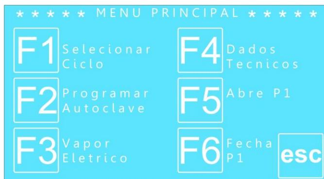
Nesta tela, pressionando F3 pode ser alterada a forma de aquecimento: vapor ou elétrico. Para ter acesso a este menu será necessário inserir a senha do operador.
