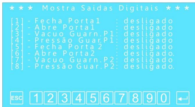
Para ligarmos ou desligarmos um determinado ponto, basta pressionar o seu numero correspondente nas teclas de função (por exemplo, para ligar a saída 1 basta pressionar 1). Se o ponto estiver ligado , o mesmo será desligado . Se o ponto estiver desligado, o mesmo será ligado.
