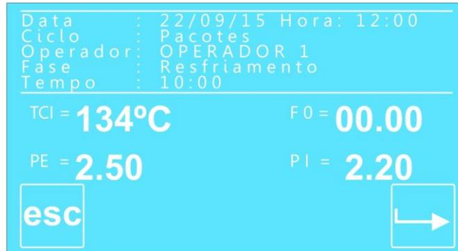
Durante o ciclo de secagem, é feito vácuo na autoclave. Quando este tempo atingir o valor programado, termina este ciclo completo e o material poderá ser retirado da autoclave. Obs:- Este equipamento possui um sistema de descarga lenta onde abre uma válvula até atingir uma pressão próxima a zero, e ai aciona a bomba de vácuo.
