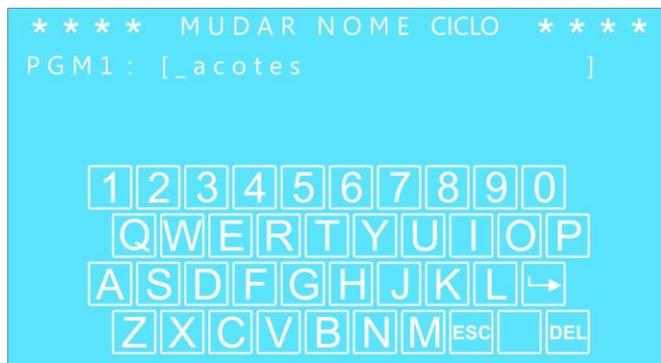
Para a escrita do novo nome proceda da mesma maneira utilizado para alterar o nome do operador. Pressione ENTER para confirmar ou ESC para abortar a modificação.
