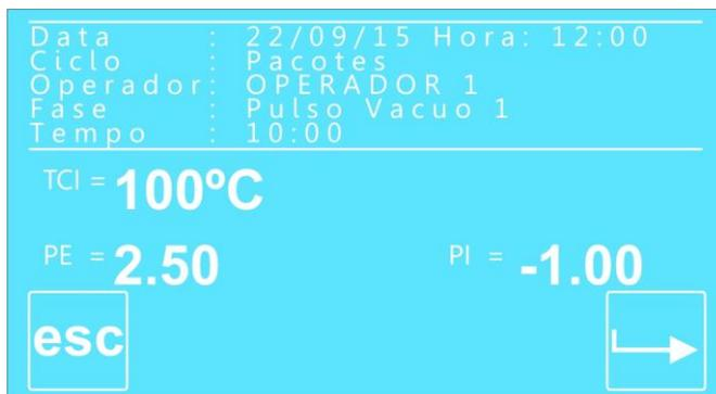
Indicando que estamos no ciclo de Pré Vácuo e também a temperatura e pressão da câmara interna naquele momento. Durante todo o ciclo teremos no display a indicação da temperatura e pressão da câmara externa e interna, bem como se o equipamento esta aplicando pressão ou vácuo a câmara interna.
